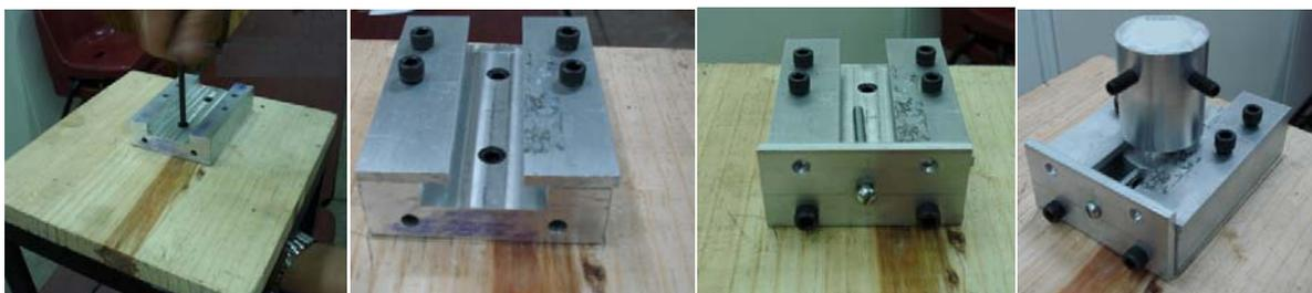
**Figura 4.22** Dispositivo de sujeción para las pruebas experimentales.
