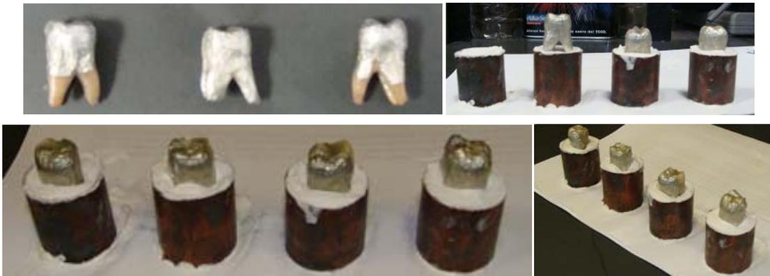
**Figura 4.21** Pegado de la resina, aluminio y colocación de los dientes en las probetas de experimentación.
