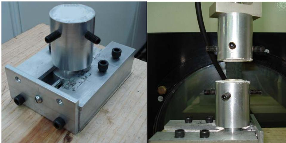
**Figura 4.9** Dispositivo de sujeción (maquinado).
