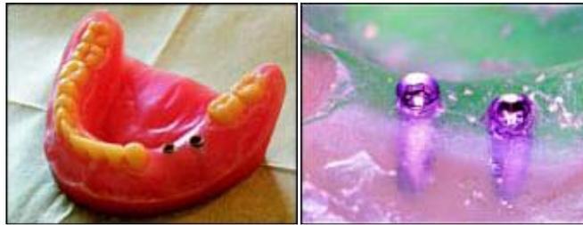
**Figura 1.17** Análisis fotoelástico de un implante, [1.23].
