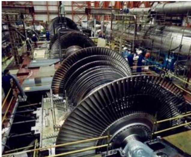
Figura 1. 1 Turbina de vapor Mitsubishi para una planta nuclear
