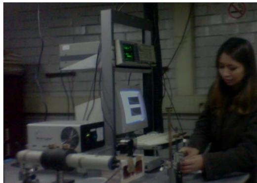
**Figura 24.** Arreglo experimental real de la celda fotoacústica abierta
