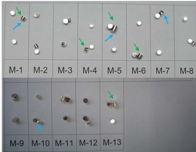
Foto de probetas después de prueba de corrosión donde se indican con las flechas de color verde las muestras con cambio de color y las de color azul con pérdida de brillo.
