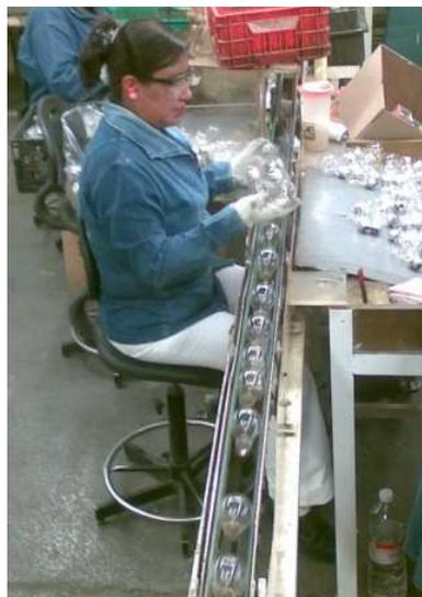
Figura 1.3.3.- Inspección visual de lámparas A-17.
