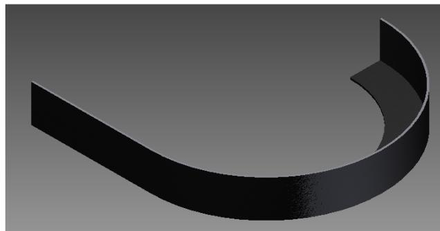
Figura 5.2.5.1.- Diseño de la guía para lámparas del disco dosificador horizontal.
