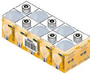
Figura 1.3.9.- Orientación y arreglo de lámparas 5x2, envueltas en plástico PVC.
