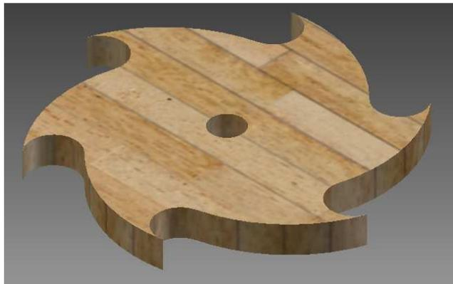
Figura 5.2.4.1.- Diseño del disco dosificador horizontal.
