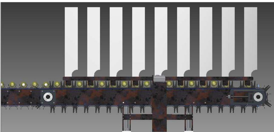
Figura 5.4.1.9.- Dibujo de ensamble del sistema de inserción de lámparas en transportador de cadenas vista posterior.
