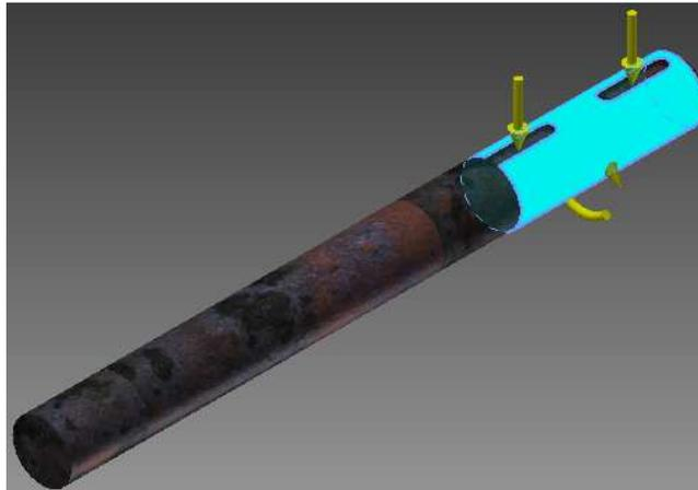
Figura 4.4.3.16.- Condiciones de carga del modelo sólido.
