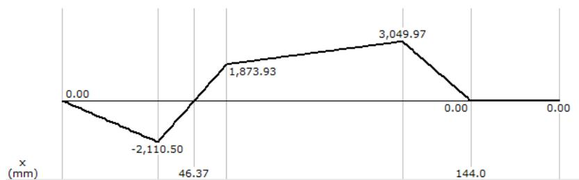
Figura 3.3.9.- Diagrama de momento flexionante en el plano horizontal.
