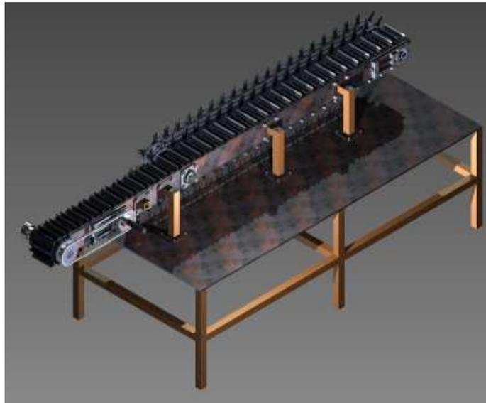
Figura 4.4.12.5.- Ensamble transportador de cadenas vista isométrica.
