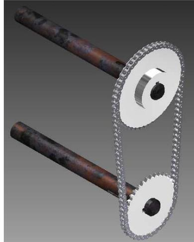
**Figura 4.4.4.2.-** Orientación a 90° de la rueda dentada motriz del eje conducido tres con respecto a la rueda dentada conducida del eje conducido cuatro.
