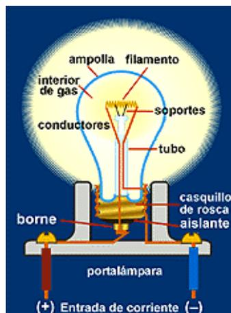
Figura 1.1.1- Elementos que forman una lámpara incandescente.
