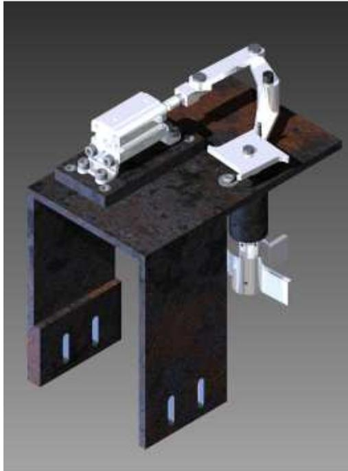
Figura 3.5.14.-Ensamble dosificador de lámparas vista isométrica.
