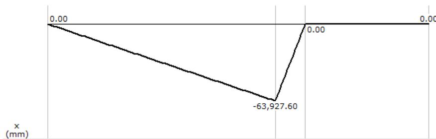
Figura 4.4.4.6.- Diagrama de momento flexionante en el plano horizontal.
