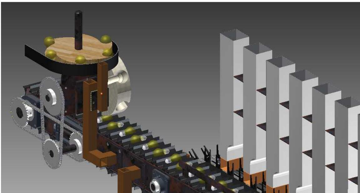
Figura 5.2.8.7.- Dibujo de ensamble orientador de lámparas y transportador de cadenas con producto.
