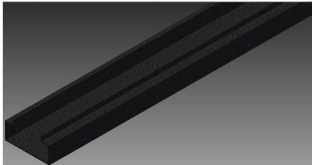
Figura 4.4.9.1.- Diseño de guías para cadenas.
