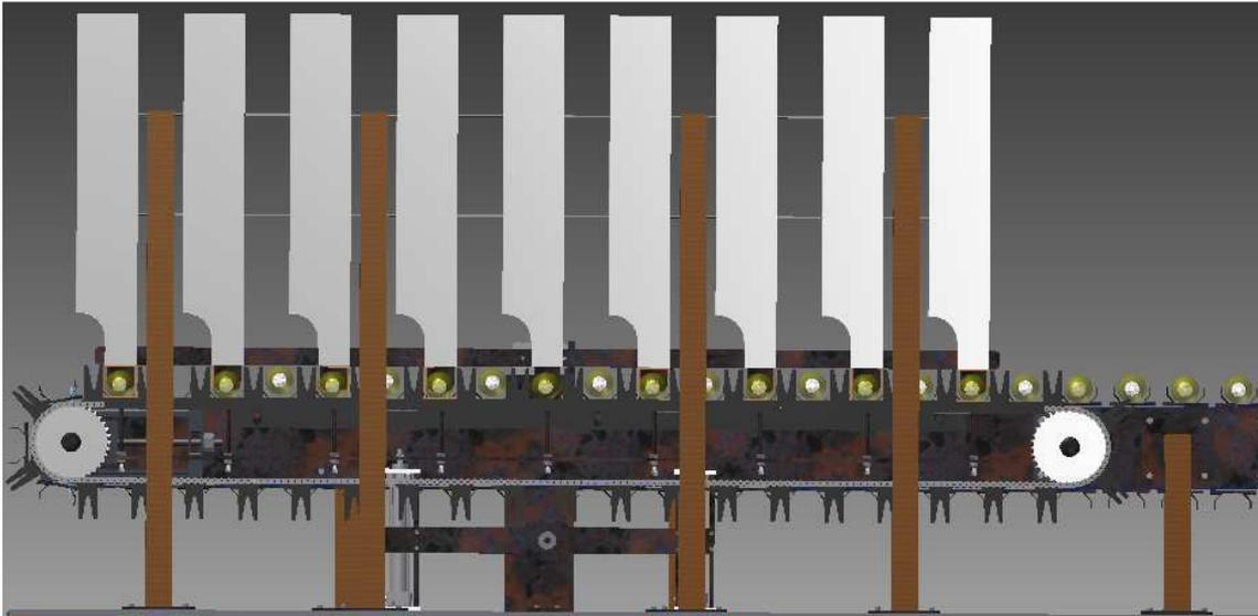
Figura 5.1.6.- Ensamblaje acumuladores de forros en transportador de cadenas vista posterior.
