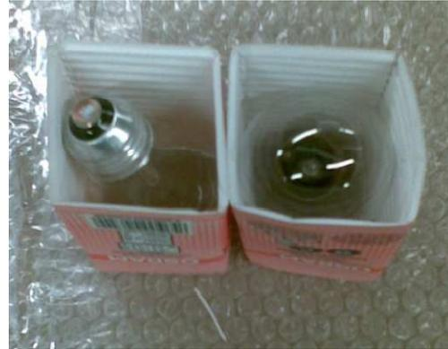
Figura 1.3.8.-Orientación de lámparas en forros.
