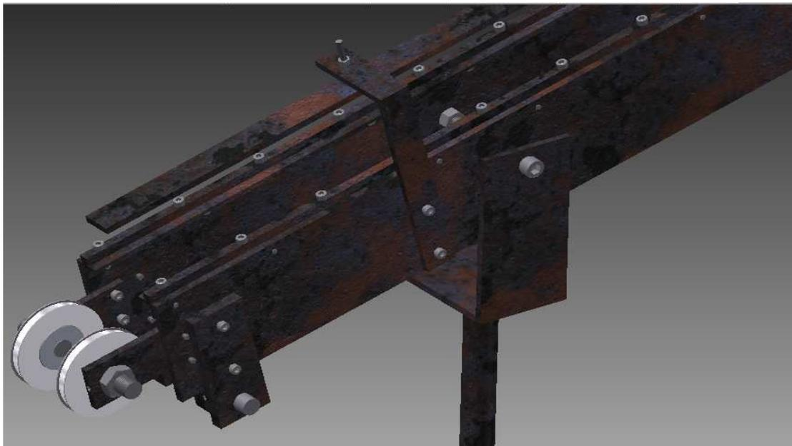
Figura 3.5.9.-Ensamble transportador de ligas sección inclinada, perspectiva elementos de soporte.
