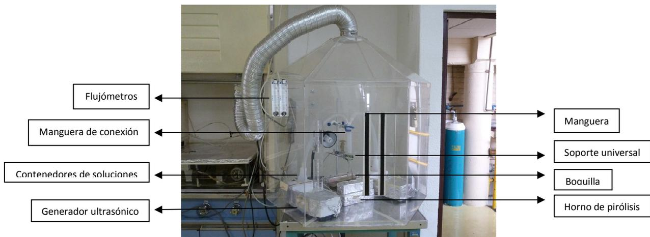
Figura 3.1 Sistema de rocío pirolítico ultrasónico empleado para el depósito de las películas.
