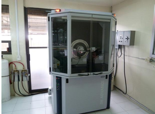
**Figura 3.4 Difractómetro de rayos X.**
