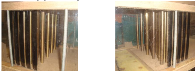
Figura 3.2.11 Zona de pruebas con comportamiento de flujo adecuado.
