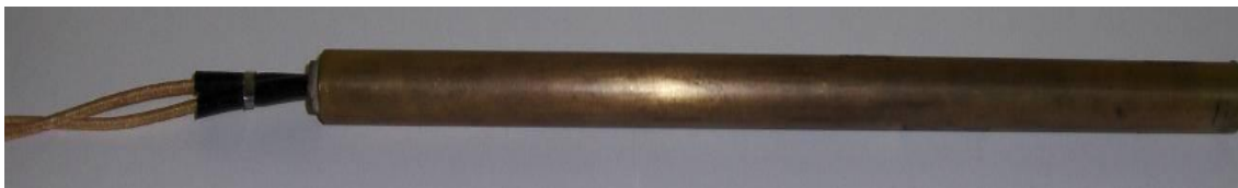
Figura.3. 2.16 Calorímetro (tubo exterior de latón, tubo interior de cerámica, e hilo de nicromo Ni-Cr).
