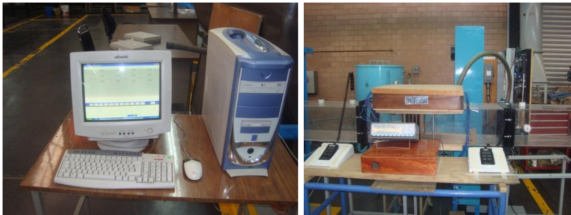
Figura 3.2.19. Conexión física del sistema de mediciones de temperatura.
