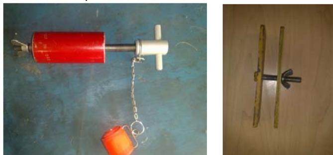
Poste inmovilizador rotor de cola, y herramienta de pedales
