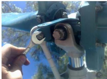
Conexión de las varillas de cambio de paso
