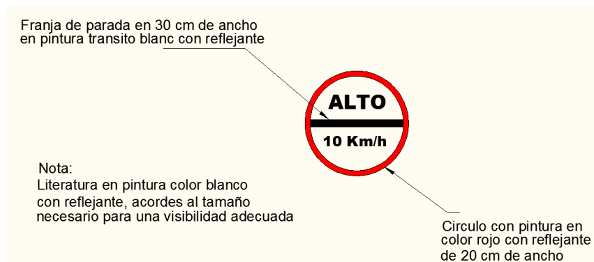
Ilustración 16 Marca de parada para vehículos.
