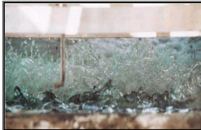
Figura 1.35.- Flujo de transición y flujo Turbulento en una rápida escalonada, se observa el flujo agua-aire, visto desde la parte superior (Chanson, 2001)
