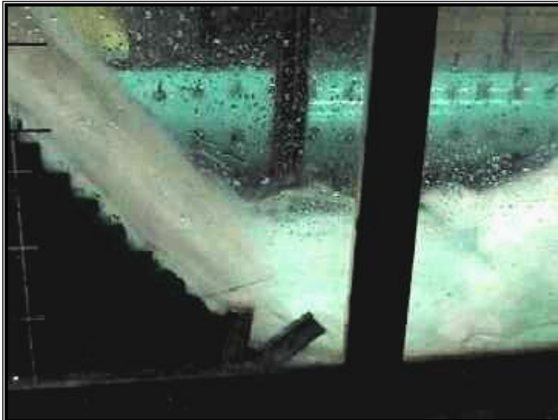
Figura 1.24.- Flujo rasante en el modelo del laboratorio de la ESIA Zacatenco
