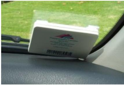
*Figura 1.5. Etiqueta RFID empleada para la recaudación con peaje electrónico.*
