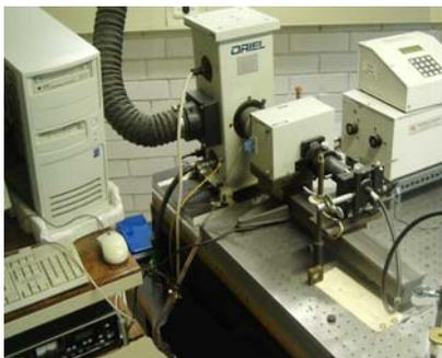
Figura 11. Montaje experimental de la técnica fotoacústica
