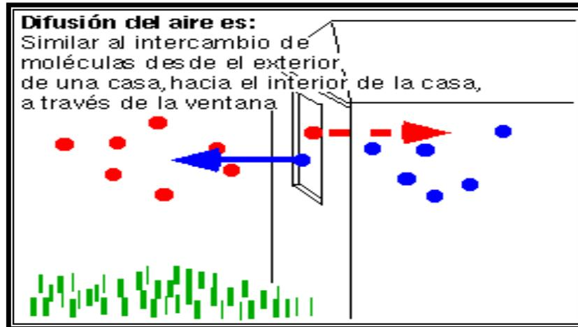
Figura 2.1 diagrama de difusión de aire a través de una ventana.
