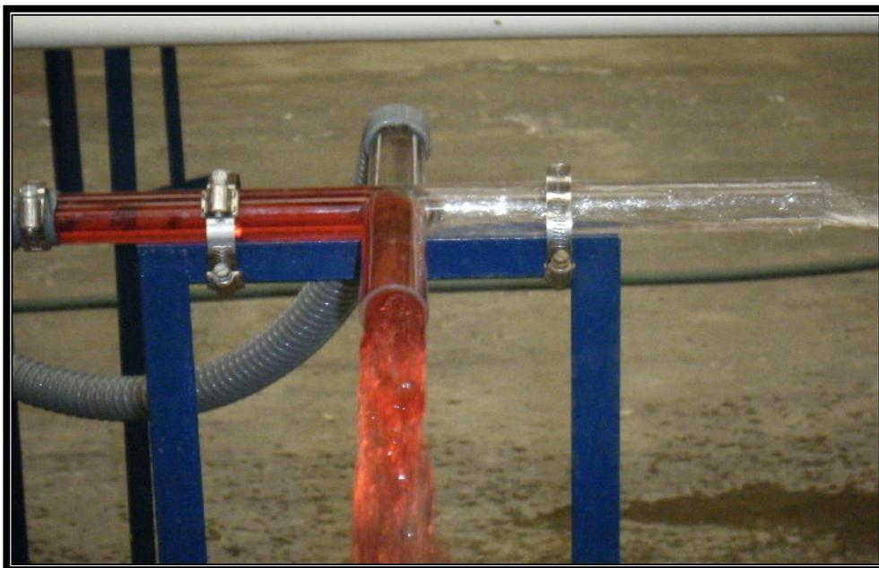
**Fotografías 3.14 Flujos en salidas de cruces sin mezcla**
