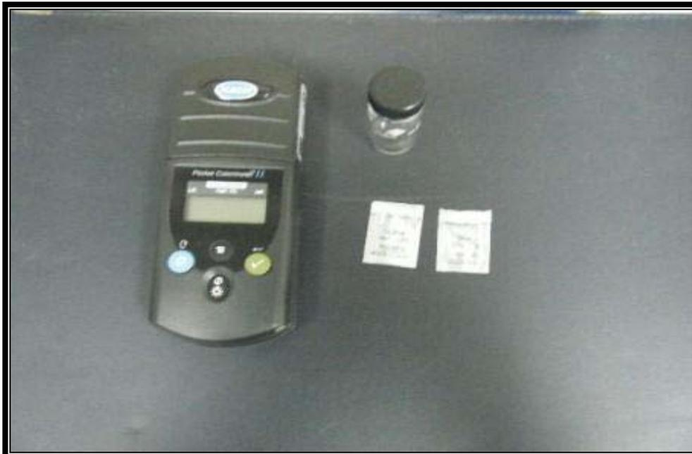
Fotografía 3.8 Colorímetro bolsillo, sirve para medir la concentración de NaOCl
