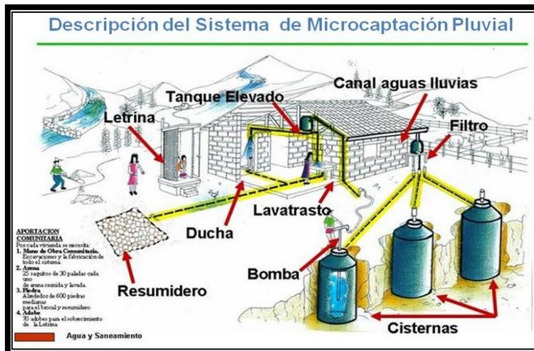
Figura 1.4 Descripción del sistema de captación de agua pluvial
