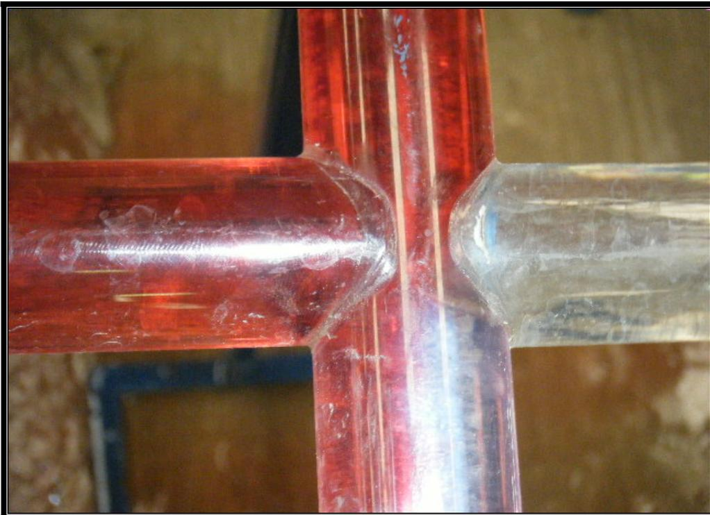
Fotografía 3.18 Choques de flujos entrantes en cruces de tuberías
