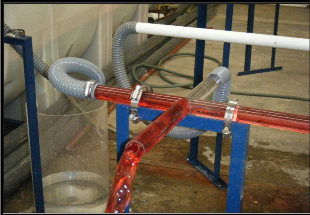
Fotografía 3.17 mezcla de flujos entrantes en cruces de tuberías
