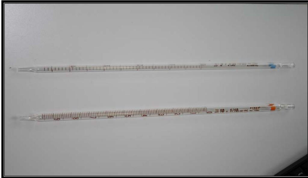
**Fotografía 3.5 Pipeta graduada para medir volumen de cloro**
