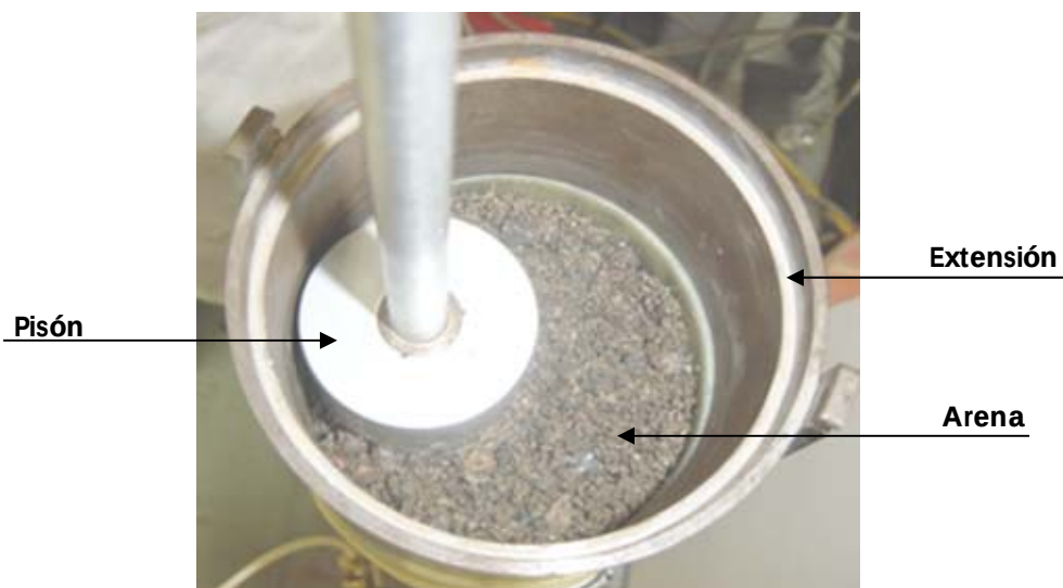
Figura 3.5 Proceso de formación de la probeta por compactación
