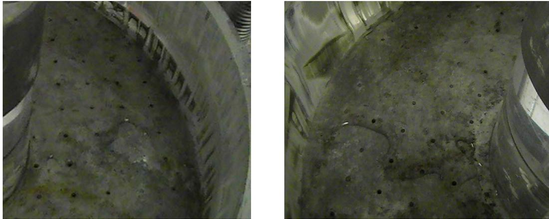
Figura B.14. Agua expulsada por la presión del gas metano durante la reconstitución de la arcilla
