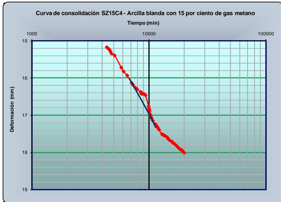
Figura A.8c. Detalle del tramo la consolidación primaria, SZ15C4.
