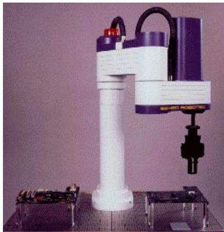
**Figura 3.3:** Manipulador tipo SCARA
