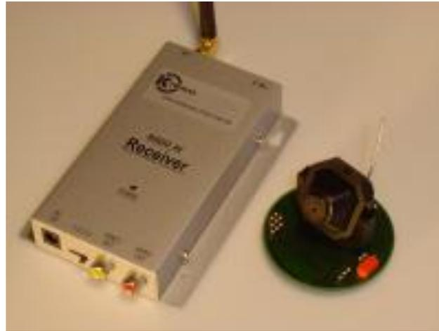
**Figura 4.1:** Torreta de visión cámara CMOS inalámbrico y receptor inalámbrico de audio y video.
