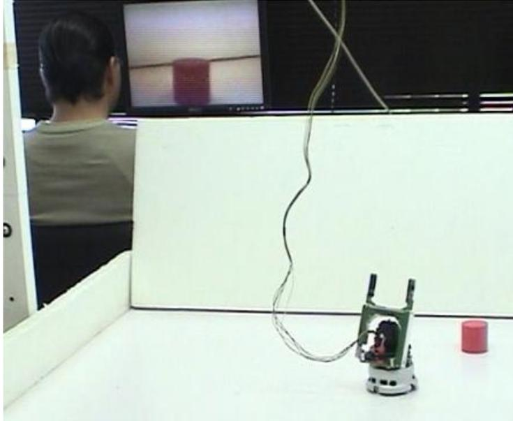
**Figura 5.1:** En esta figura se muestra el monitor de observación, el usuario. A través de la cámara montada sobre el robot, se observa un cilindro rojo.
