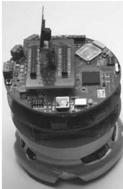
**Figura 2.3:** Robot Khepera II equipado con un módulo FPGA y una cámara
