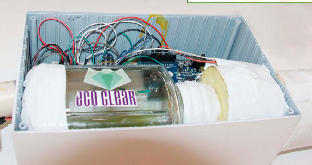
Químico y Sistemas Digitales, respectivamente, consta de un tubo de PVC, dos sensores y un filtro de vidrio, además de un sensor que detecta el contaminante que ingresa al dispositivo y otro que indica el fin del proceso en el que se obtiene aire limpio.
