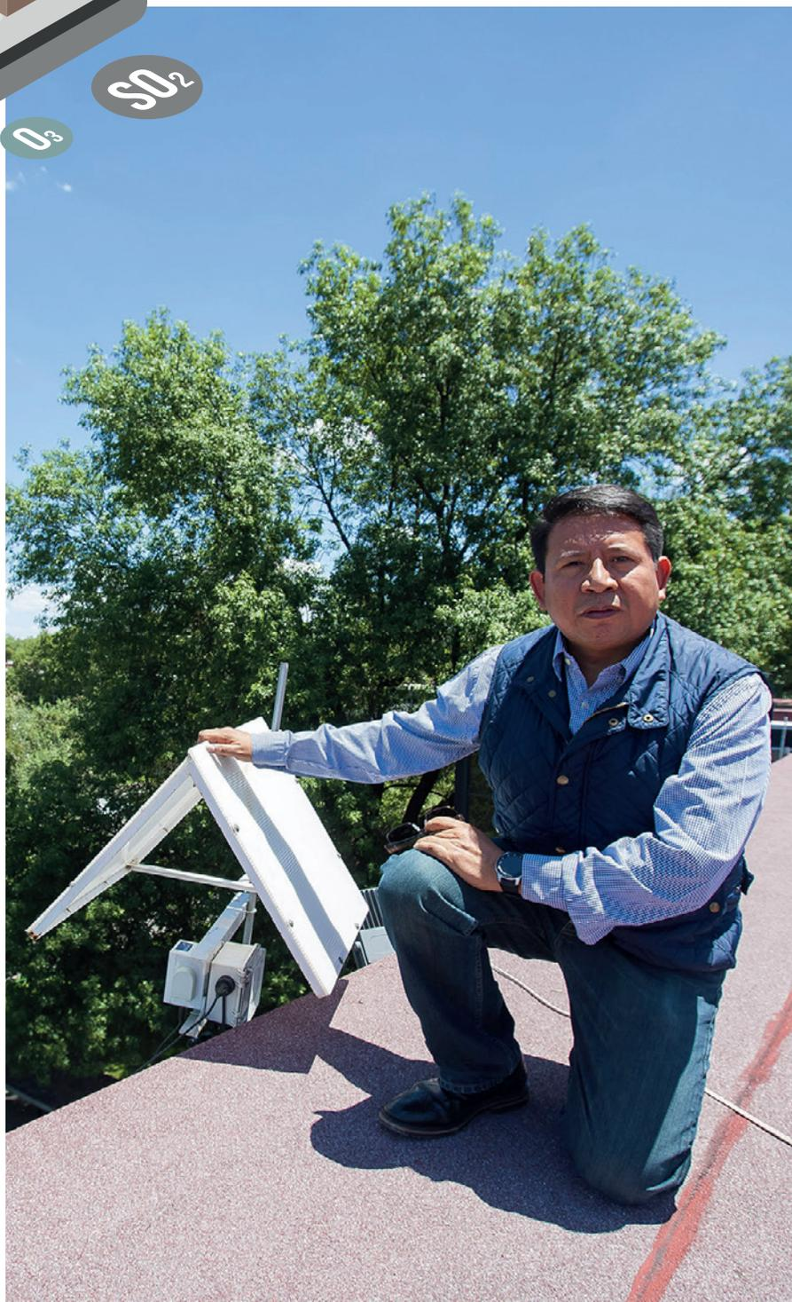
Las estaciones móviles poseen tarjetas electrónicas para coleccionar y procesar la información de gases contaminantes y partículas suspendidas, un sonómetro y una estación meteorológica
