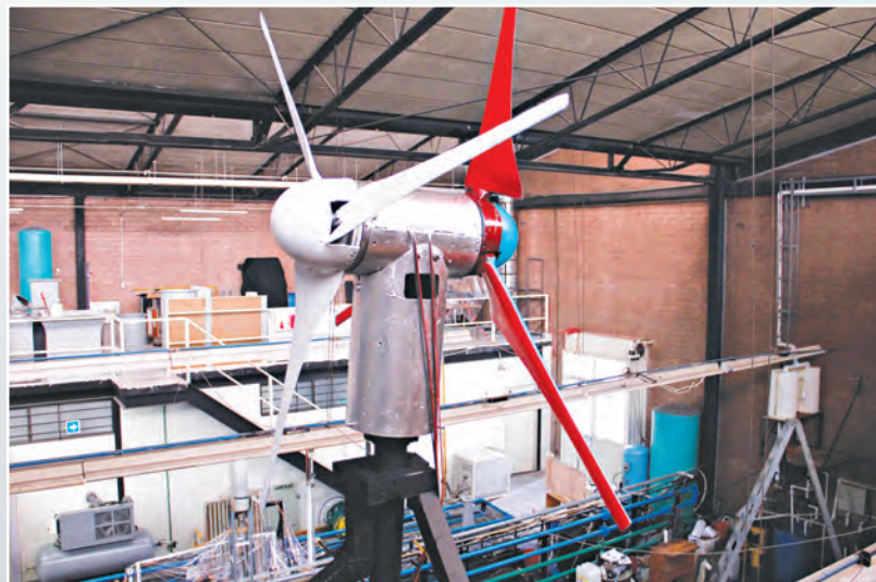
Este aerogenerador es único en su tipo a nivel internacional porque logra conjuntar el movimiento contragiratorio de las paletas en una sola máquina. (Foto: Daniela Pérez)
