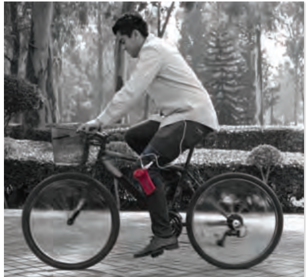
► El dispositivo se coloca en la rodilla mediante una estructura de aluminio con dos pequeñas varillas ajustadas por resortes a la pierna
