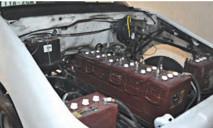
► Conversión de motor de combustión interna a motor eléctrico
