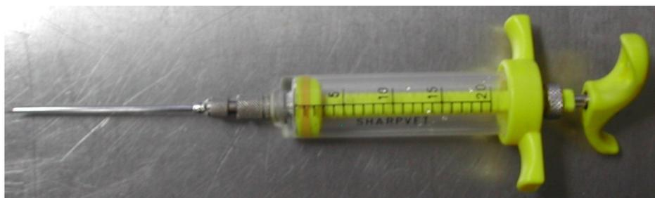
**Figura 12. Inyector ideal usado para introducir 10 mL el trazador al ICSR.**
