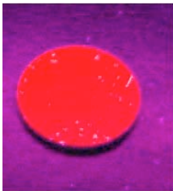
Figura 4.50 Fotografía del polvo luminóforo de \text{Y}_2\text{O}_3:\text{Pr}^{3+} (0.25 a/o) sintetizado a 1100 °C, que emite fotones principalmente en la longitud de onda de 620nm y que corresponde al color rojo-naranja.
