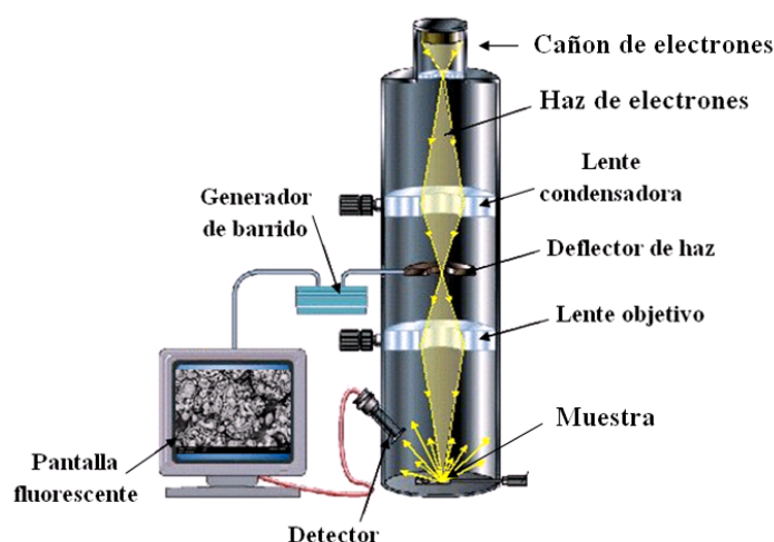
Figura 2.20. Principales componentes del MEB.
