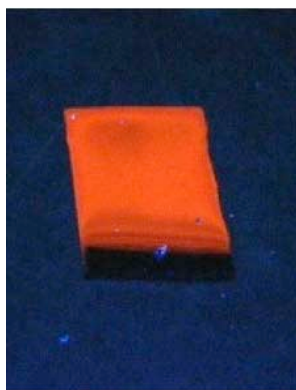
Figura 4.10 Fotografía de la película luminófora que emite fotones principalmente con una longitud de onda de 611nm y que corresponde al color rojo-naranja debido a la transición ^5D_0 \rightarrow ^7F_2 .
