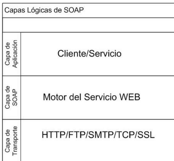
Figura 2: Detalle de las capas lógicas de SOAP <sup>23</sup>.
