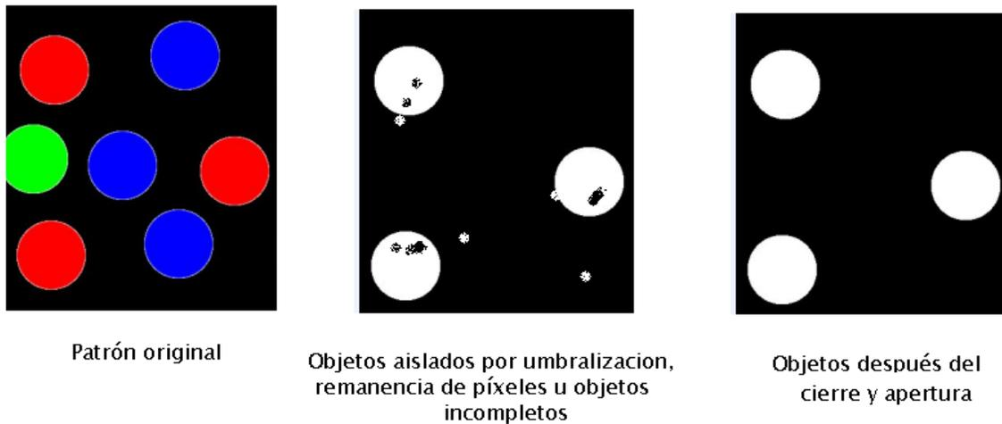
Figura 16. Umbralizado, apertura y cerradura (Ejemplificación exagerada)
