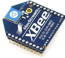
**Figura 41.** Módulo XBee Serie 1.
