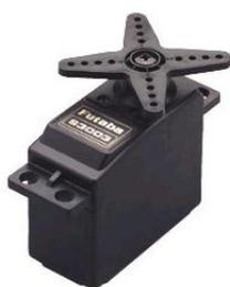
**Figura 36.** Imagen del servomotor Futaba 3003.
