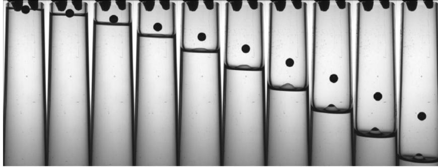
Figura 2.1: Caída libre de un balón de acero en comparación con la superficie libre del líquido en el Tubo 1, con etanol. Las fotografías están igualmente espaciadas en tiempo.
