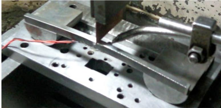
**Figura IV.16.-** Posicionamiento de la probeta durante el electroerosionado
