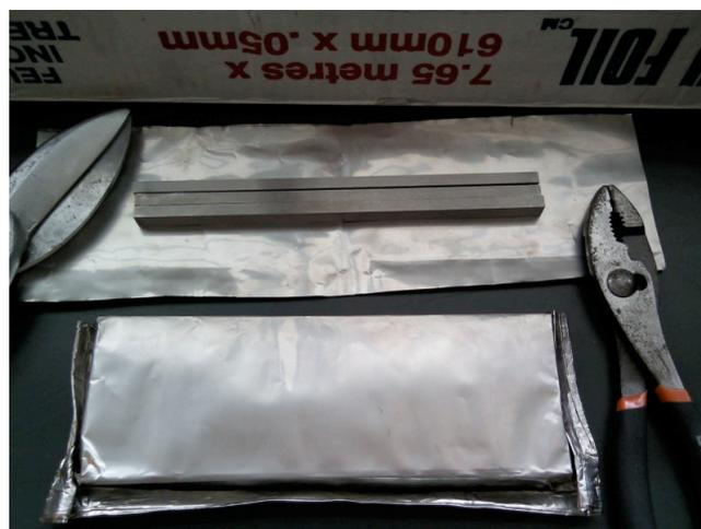
**Figura IV.3.-** Paquetes de probetas que se sometieron al tratamiento térmico de recocido
