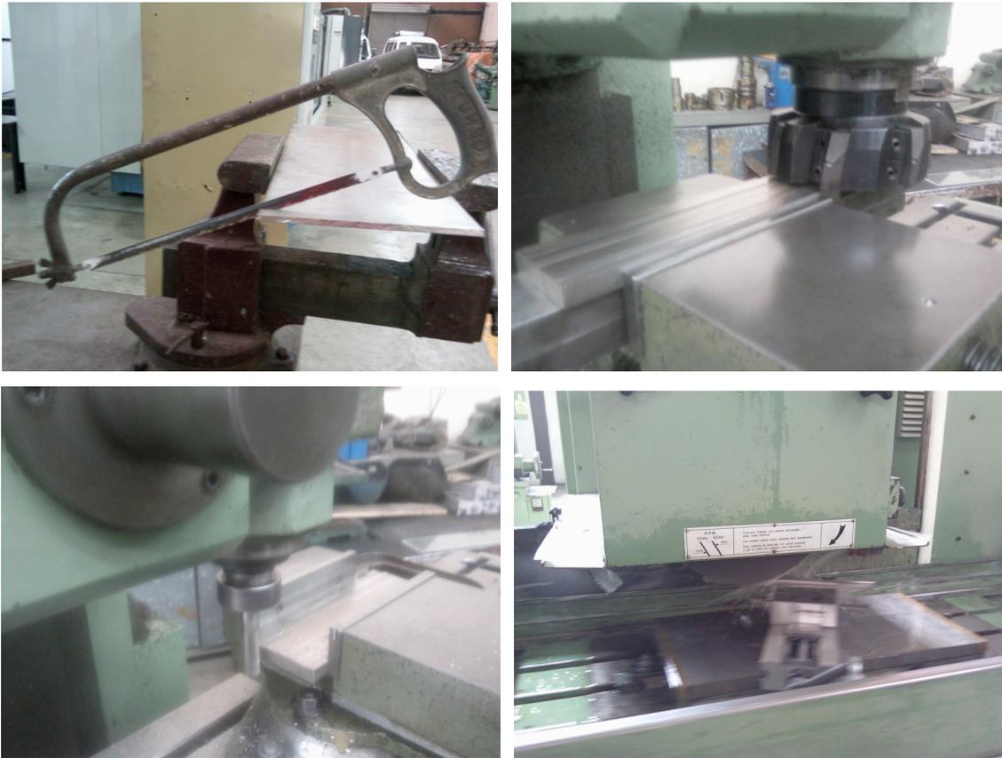
**Figura IV.2.-** Procesos de manufactura de las probetas
