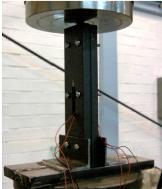
**Figura IV.32.-** Deformado axial en compresión de la probeta
