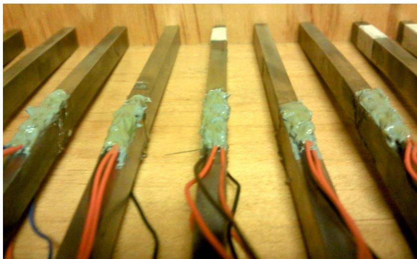
**Figura IV.15.-** Recubrimiento de la galga extensométrica
