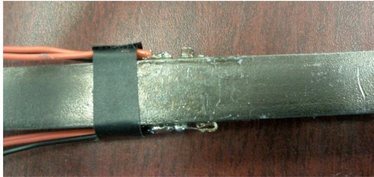
**Figura IV.5.-** Colocación de las galgas extensométricas
