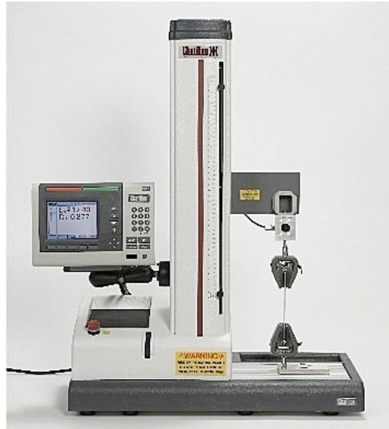
**Figura II.2.-** Máquina para ensayos de tensión.
