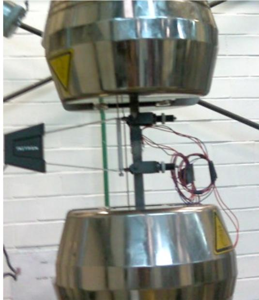
**Figura IV.23.-** Deformado axial en tensión de la probeta
