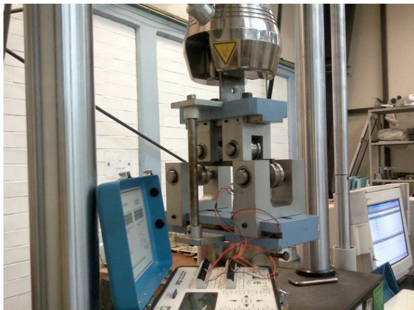
**Figura IV.17.-** Ensayo de cuatro puntos de flexión
