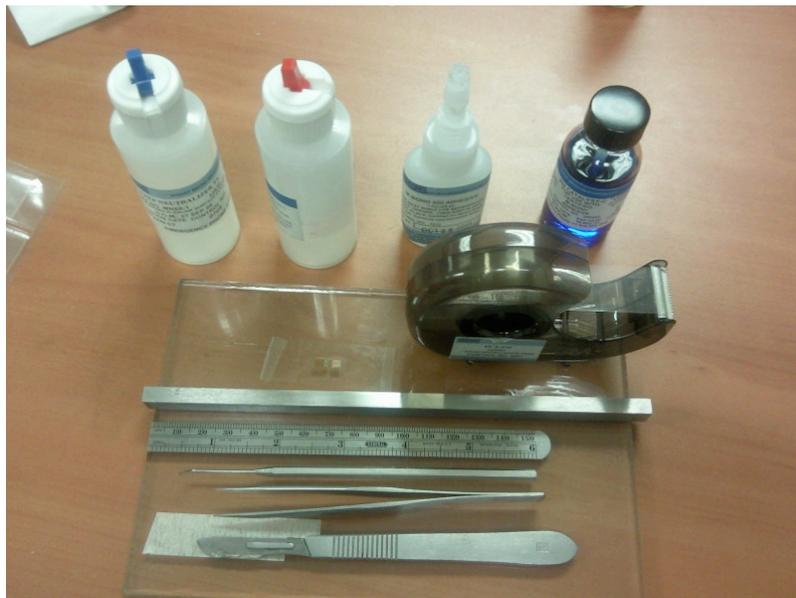
**Figura IV.6.-** Herramientas para el pegado de la galga extensométrica
