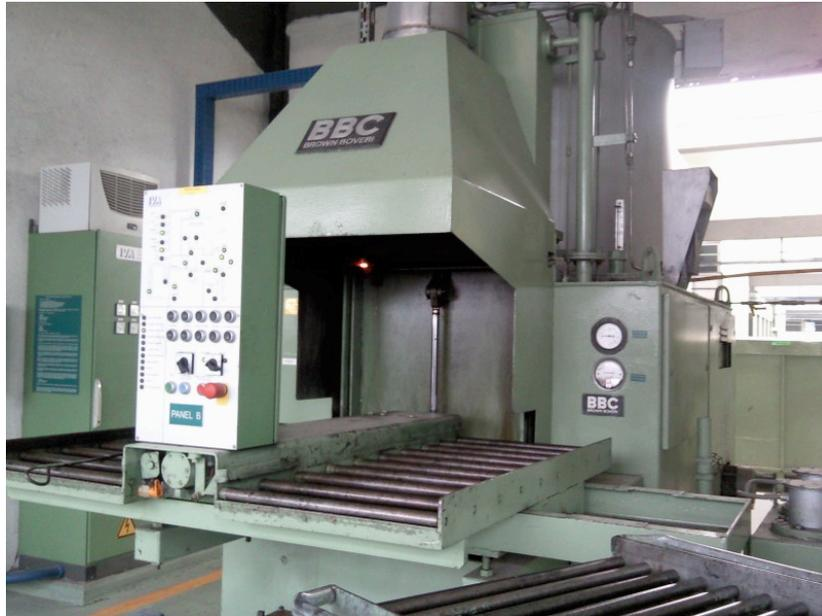
**Figura IV.4.-** Horno empleado para el tratamiento térmico
