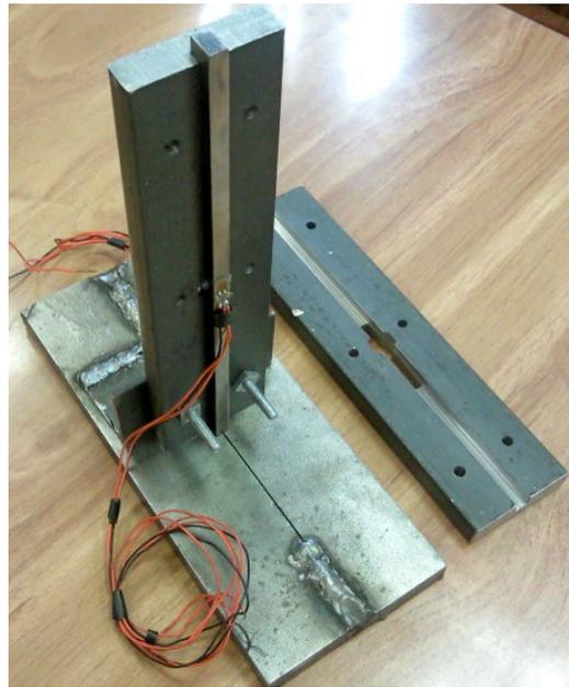
**Figura IV.10.-** Dispositivo de compresión de probetas
