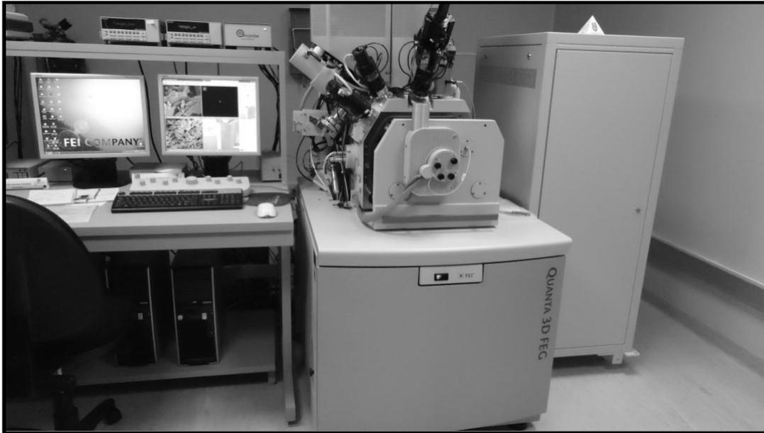
Fig. 3.13. Microscopio electrónico de barrido (MEB, por sus siglas en inglés) marca FEI modelo Quanta™ 3D FEG.
