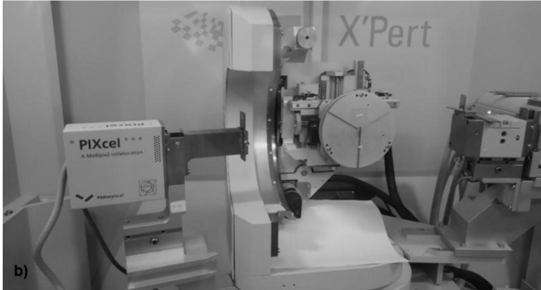
Fig. 3.17 a) Característica básica de un experimento típico de XRD (ASM Handbook Committe Metals Handbook, 1992). b) Equipo de difracción de rayos X que consta de un haz de rayos X incidente (a la izquierda de la imagen), porta muestras (al centro de la imagen) y deflector a la derecha de la imagen.
