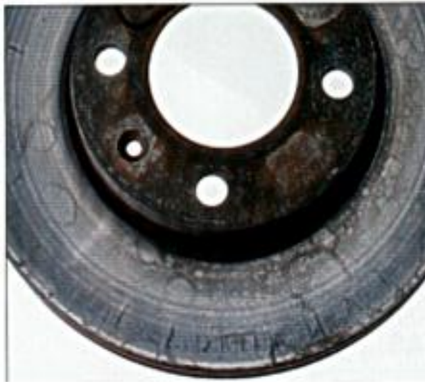
Figura 2.9 Superficie azulada y pequeñas fisuras en disco
