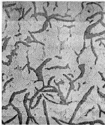
Figura 3.1 Microestructura fundición gris
