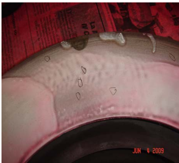
Figura 4.15 Aplicación de líquidos penetrantes a pista exterior del disco
