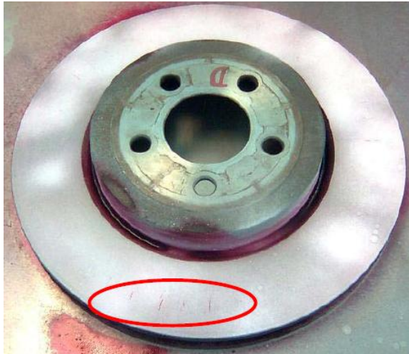
Figura 4.19 Aplicación de líquidos penetrantes a disco diseñado
