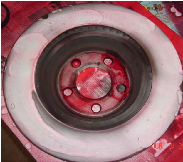
Figura 4.16 Aplicación de líquidos penetrantes a pista interior del disco
