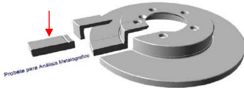
Figura 4.6 Probete para análisis metalográfico.
