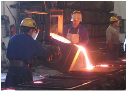
Figura 4.2 Proceso de colada del material
