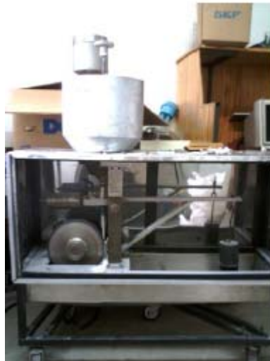
Figura 4.21 Maquina tribologica de abrasión seca
