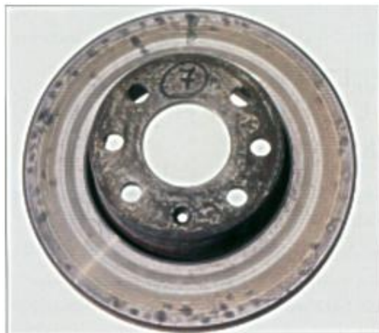
Figura 1.5 Puntos de concentración de calor
