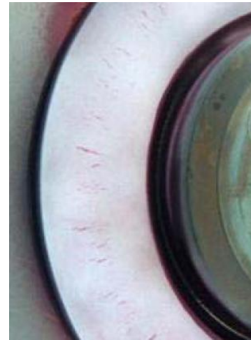
Figura 4.20 Revelación de grietas en pista exterior
