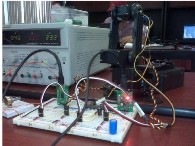
**Fig. 6.2.** Interfaz realizada para control de servomecanismo.
