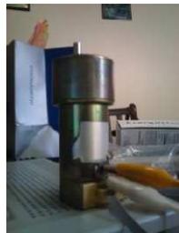
**Fig. 4.38. Imagen del motor Pittman serie 14000.**
