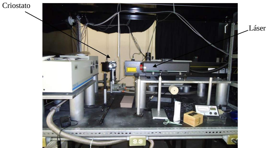
Figura 2.4 Equipo utilizado para hacer las mediciones de fotoluminiscencia.
