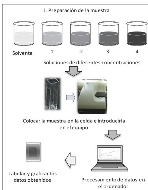
Figura 2.15 Diagrama experimental para la caracterización de las muestras por Dispersión Estática de Luz
