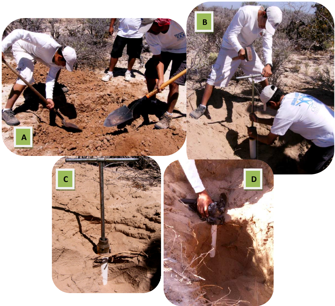
Figura 17. Procedimiento para la colecta de núcleos de sedimentos de dunas antiguas para fechación por termoluminiscencia. (A) se excava una trinchera; (B y C) a la profundidad de 38 cm de la superficie del terreno se introduce un nucleador de pvc; (D) se extrae el tubo de pvc, cubriéndolo con plástico negro para evitar el contacto de la luz.
