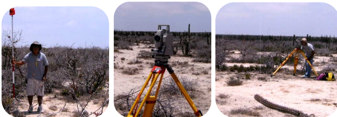
Figura 15. En la Zona Central del área de estudio se realizaron 2 perfiles con estación topográfica, con la finalidad de conocer la altura de los depósitos eólicos antiguos.
