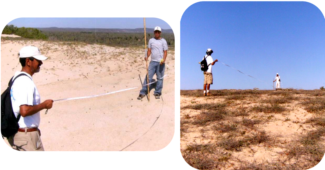
Figura 14. Los perfiles de playa fueron realizados con ayuda de cinta métrica, nivel de mano y estatal.
