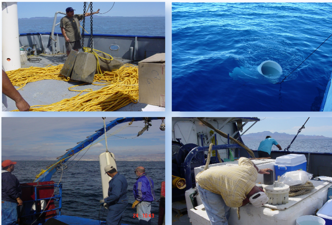
Figura 10. Secuencia de maniobras para la recuperación de la trampa de sedimentos.
