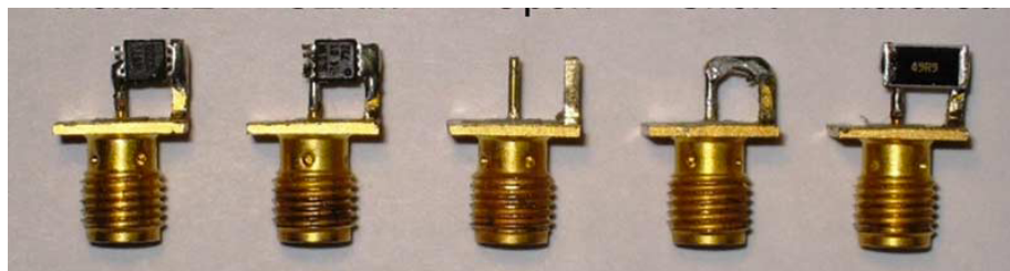
Figura. 2-19 Método de Calibración Utilizando Conectores SMA de 50\ \Omega
