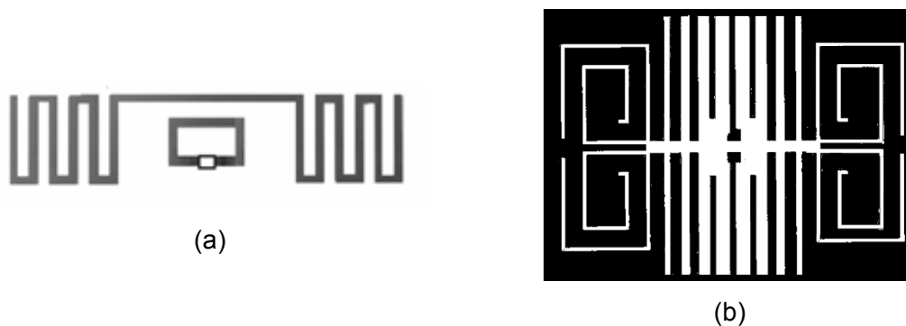
Figura. 2-9 Ejemplos de Antenas de RFID. En (a) antena serpenteada y (b) antena de ranura.
