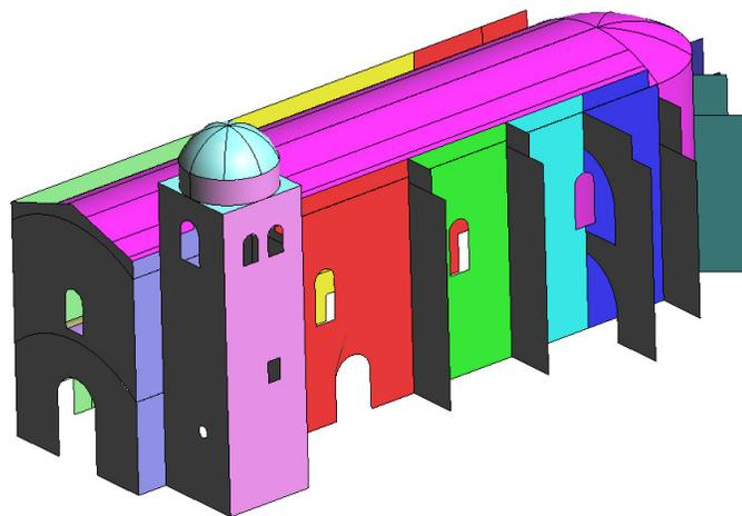
Fig. \_\_ Generación de superficies. Cada color simboliza el diferente grupo físico que poseerá sus propias características geométricas y mecánicas.
