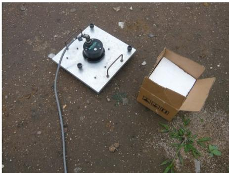
**Figura 3.25. Acelerómetro triaxial**
