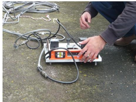
**Figura 3.26. Acelerómetro uniaxial**
