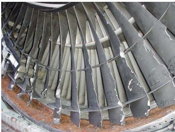
Figura 2.27 Destrucción de los alabes del compresor.
