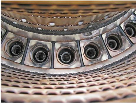
Figura 2.29 Daño por sobrecalentamiento de la cámara de combustión.
