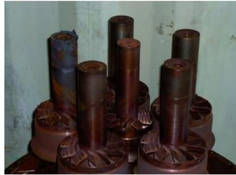
Figura 2.30 Daño en los inyectores de combustible de la cámara de combustión.
