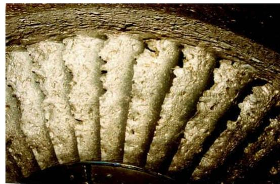
Figura 2.28 Erosión en los alabes de compresor.
