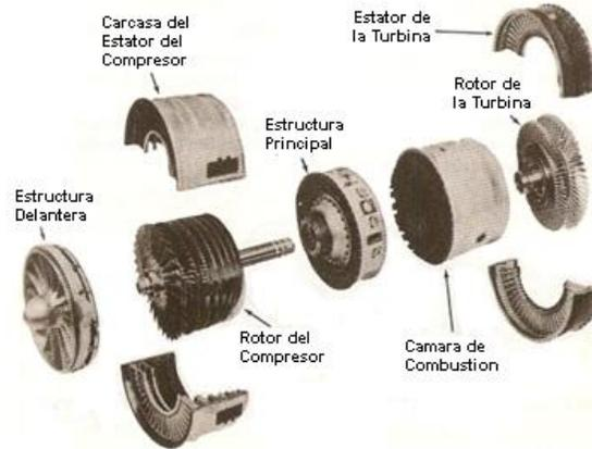
Figura 2.3 Motor de turbina de gas con sus componentes mostrados por separado.
