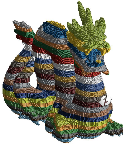
Figura 2-60. Ejemplo de rebanado de la superficie virtual
