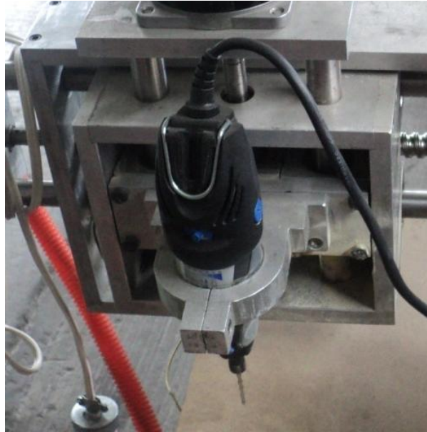
Figura 3-17. Fotografía del mototool y la herramienta de corte montado en la máquina
