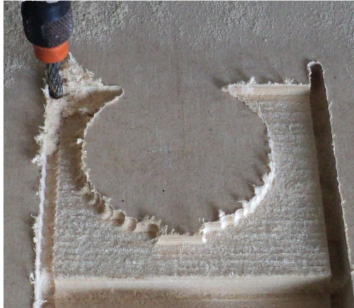
Figura 4-28. Fotografía del maquinado de las últimas rebanadas en el desbaste
