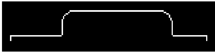
Figura 2-67. Imagen binaria con compensación de la herramienta
