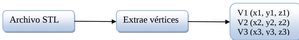
Figura 2-46. Proceso de extracción de vértices
