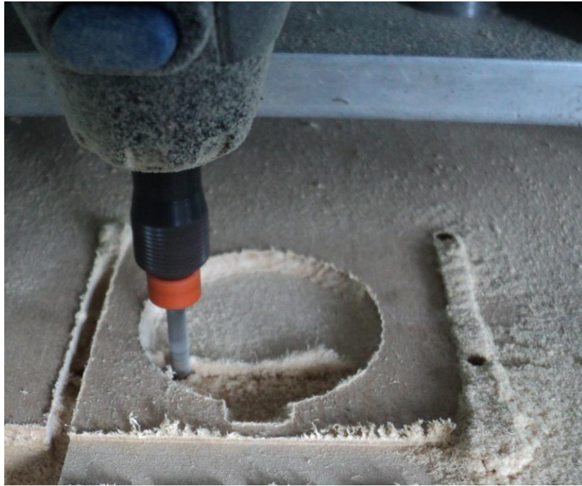
Figura 4-19. Fotografía del maquinado de la rebanada en acabado
