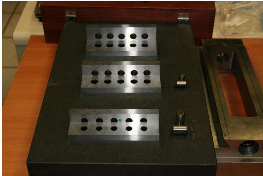
Figura 4.12 reglas paralelas y cilindros rectificados.
