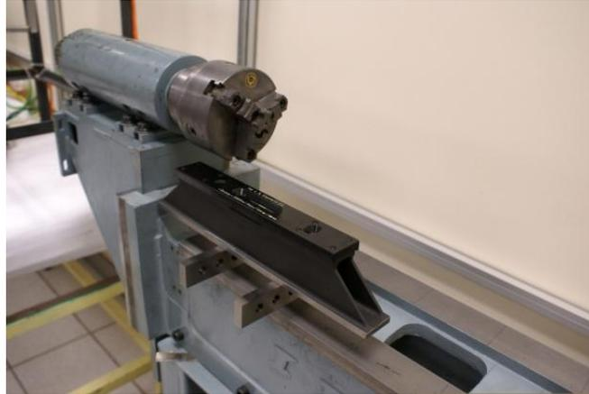
Figura 5.10. Medición de la rectitud por medio de dos reglas paralelas y el nivel de precisión
