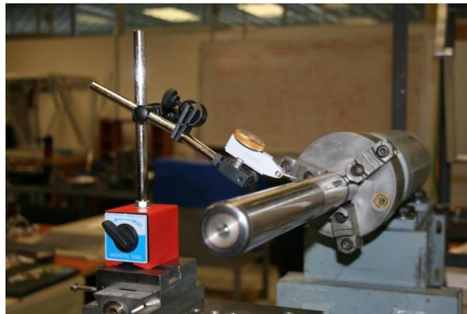
Figura 5.28. Verificación de la desviación del chuck
