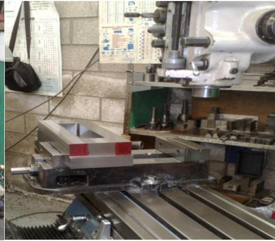
Figura 5.8 Maquinado de las guías en el carro principal.
