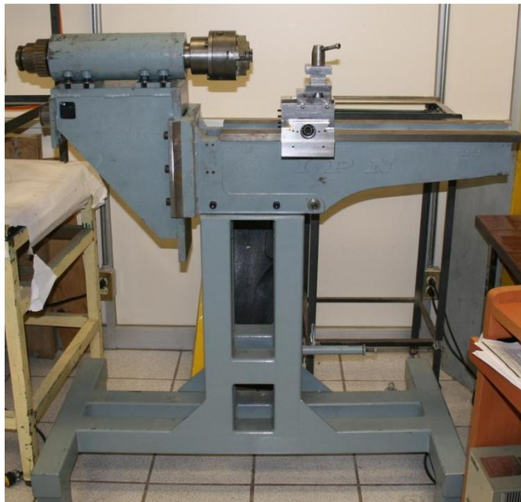
Figura 5.9 Torno Armado.
