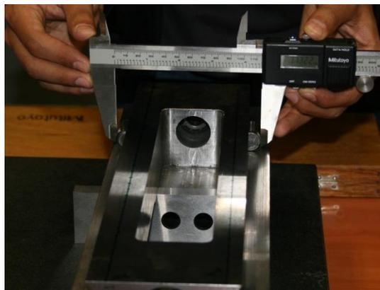
Figura 5.21. Medición entre puntos con pernos de medición.
