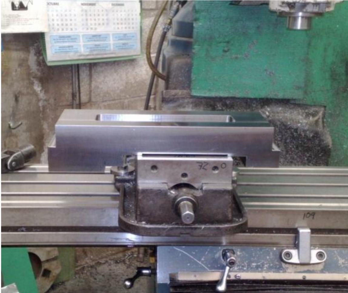
Figura 4.15. Proceso de maquinado del carro principal.
