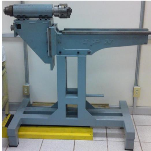
Figura 1.1 Ensamble de bancada, cabezal y estructura para torno-fresador realizado en el IPN(Hernández, 2010).
