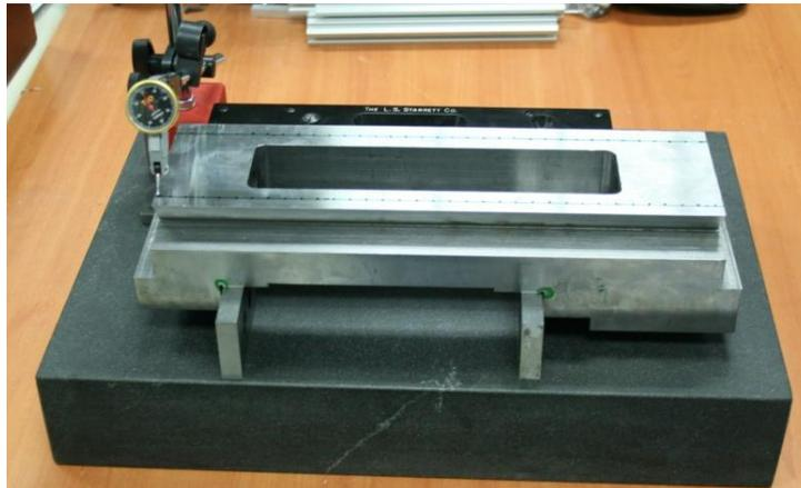
Figura 5.18. Medición del paralelismo entre la superficie de soporte de las guías planas y la guía de cola de milano.
