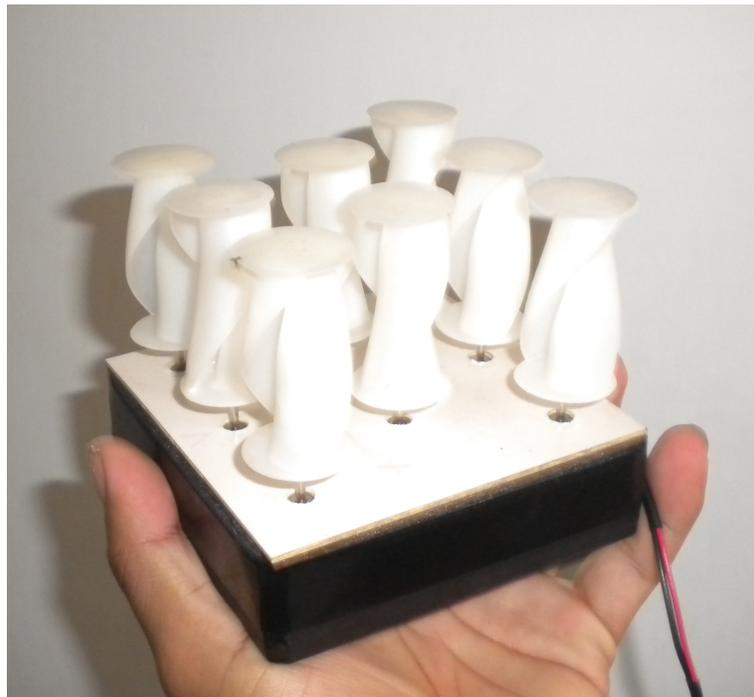
**Figura 4.14:** Módulo de aerogeneradores con turbinas Savonius torcidas
