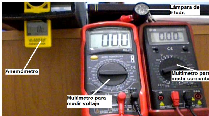
**Figura 4.22:** Equipos de medición ocupados en la adquisición de datos
