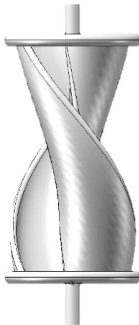
**Figura 3.15:** Vista media de la turbina Savonius Torcida analizada en [8]
