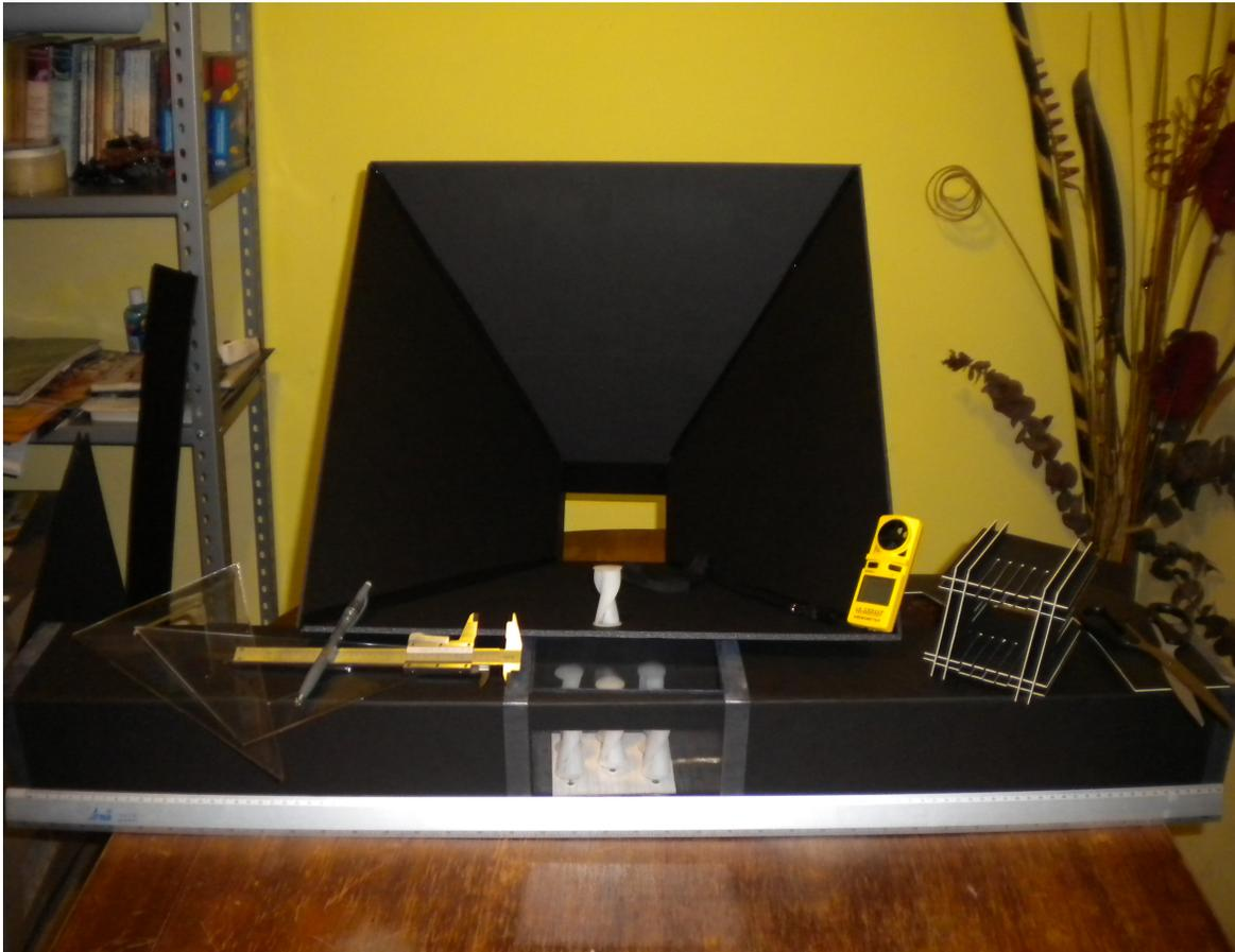
**Figura 4.16:** Construcción del tunel de viento
