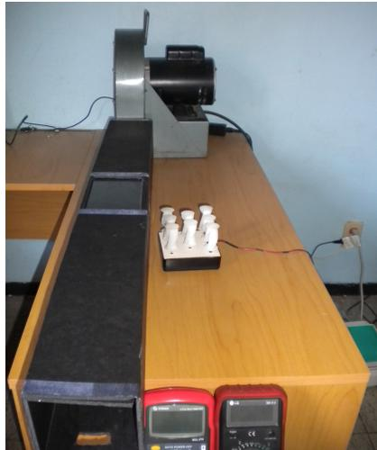
**Figura 4.20:** Montaje de la bomba de aire con el túnel de viento
