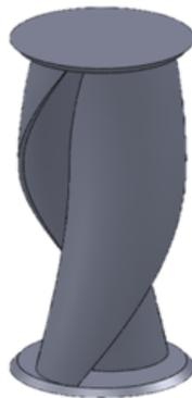
**Figura 4.4:** Turbina Savonius con flecha torcida sobre su propio eje
