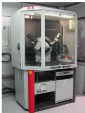
**Figura 6.** Difractómetro de rayos X (DRX)
