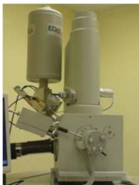
**Figura 7.** Microscopio Electrónico de Barrido acoplado a un Espectrómetro de Energía Dispersada de Rayos X.
