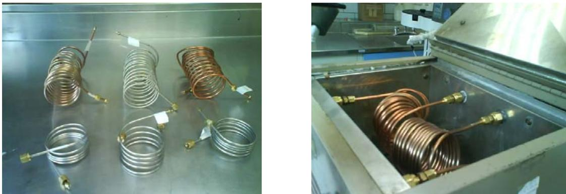
*Figura 2.2. Columnas de acero inoxidable y cobre de diferentes diámetros internos y longitudes, empacadas para la evaluación cromatográfica de las muestras (izquierda) y colocación de las columnas empacadas en el cromatógrafo de gases (derecha).*
