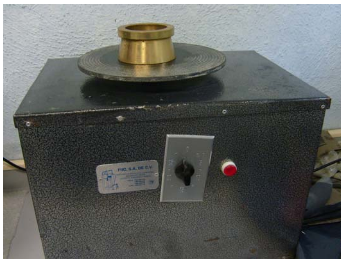
Figura 3.7. Mesa de fluidez comercial para mortero (laboratorio de concretos, CIITEC-IPN)
