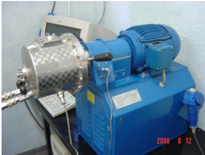
Figura 3.1. Simoloyer modelo CM01-2L marca Zoz GMBH (Laboratorio de Molienda, CIITEC- IPN)
