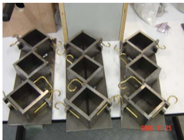
Figura 3.8. Moldes cúbicos de 5 cm para mortero (laboratorio de concretos, CIITEC-IPN)
