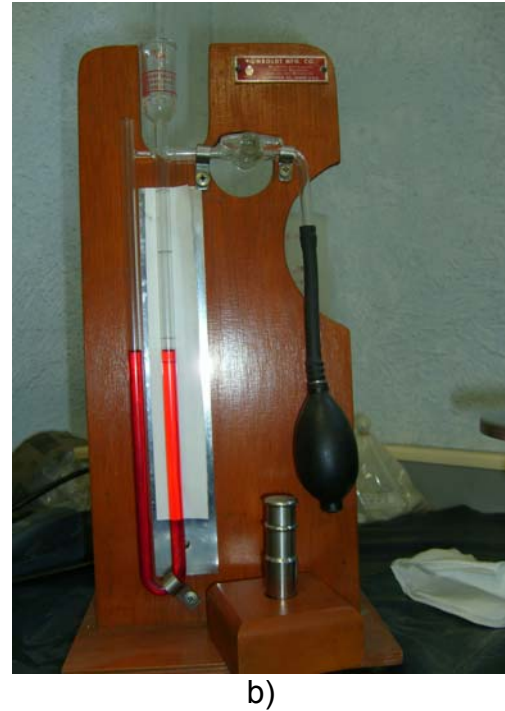
Figura 3.3. a) Esquema de dispositivo Blaine para medición de finura del cemento en apego a ASTM C-204. b) Dispositivo Blaine marca Humboldt (laboratorio de concretos, CIITEC-IPN)
