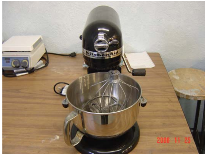
Figura 3.6. Mezcladora comercial para mortero (laboratorio de concretos, CIITEC-IPN)
