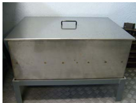
Figura 3.10. Cámara de curado de acero inoxidable para la inmersión de cubos de concreto en solución de hidróxido de calcio (laboratorio de concretos, CIITEC-IPN)
