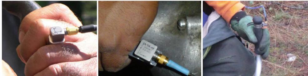
**Figura 4.4** - Formas de montaje del acelerómetro para mediciones en mano brazo.
