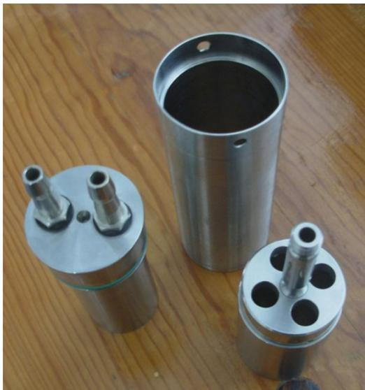
Figura 9. Sensor convencional GCC-NV de amplitud de gap de 0.35 mm.
