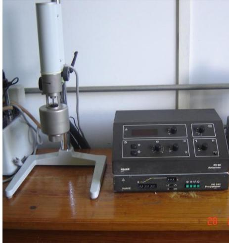
Figura 8. Viscosímetro Haake Rotovisco modelo RV20, cabezal M5.
