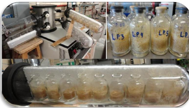
Figura 23. Liofilización del extracto dializado de lacasa.
