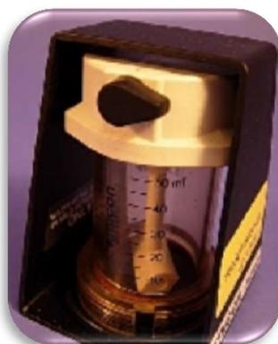
Figura 25. Fotografía del Filtro AMICON<sup>®</sup>, utilizado para concentrar la fracción enzimática de interés.
