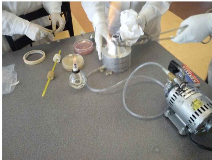
Figura 22. Contaminación biológica. Equipo Anderson. Fuente: propia
