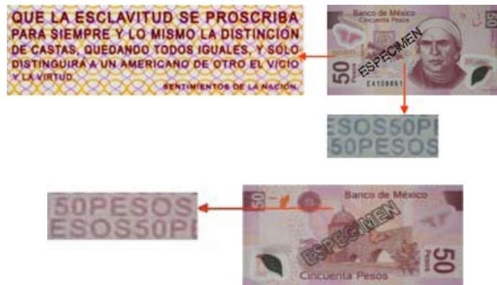
Figura 2. Microtexto impreso en el nuevo billete de $50
