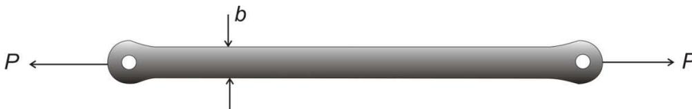
FIGURA (4.4) Biela del pistón de expansión.
