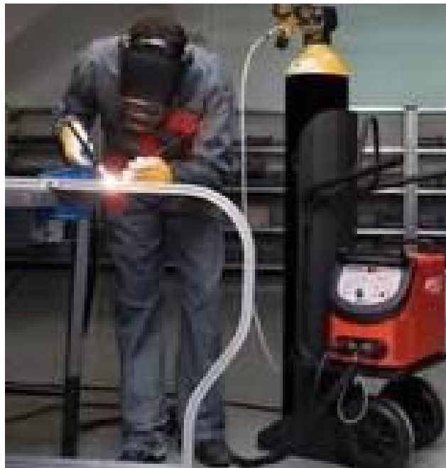
Figura I.13.- Sistema de soldadura tipo MIG
