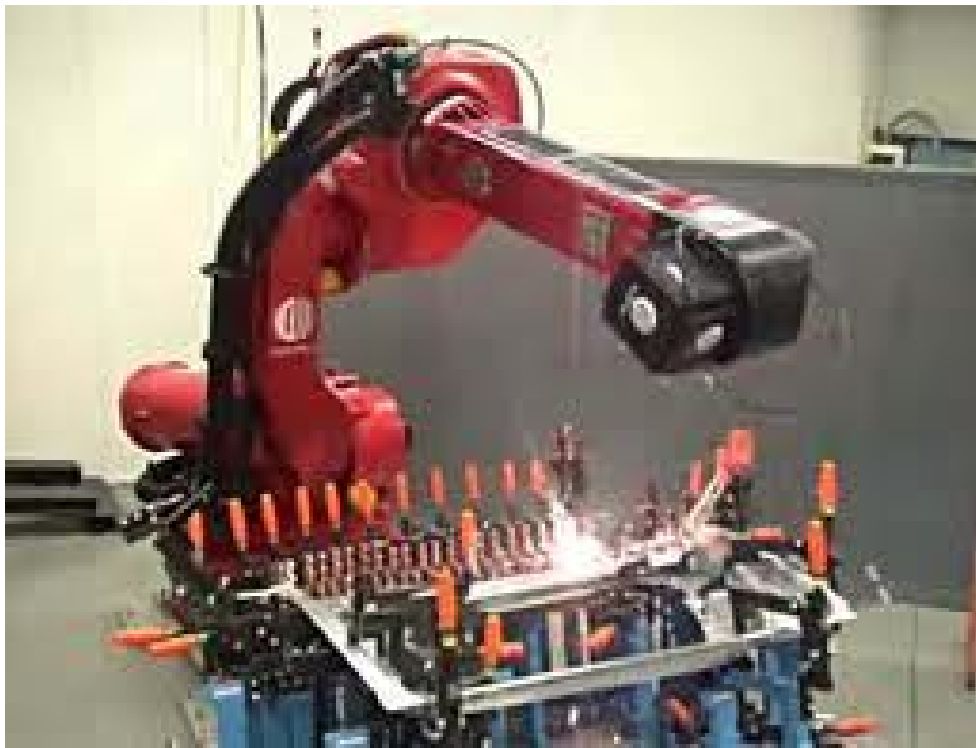
Figura I.14.- Sistema de soldadura tipo rayo láser automatizado.
