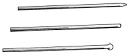
Figura II.3.- Posibles formas del electrodo de Tungsteno
