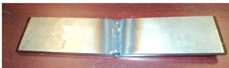
Figura VI.9.- Probetas de Acero inoxidable 316L, soldadas bajo el proceso TIG
