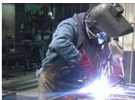
Figura VI.8.- Proceso de soldadura TIG
