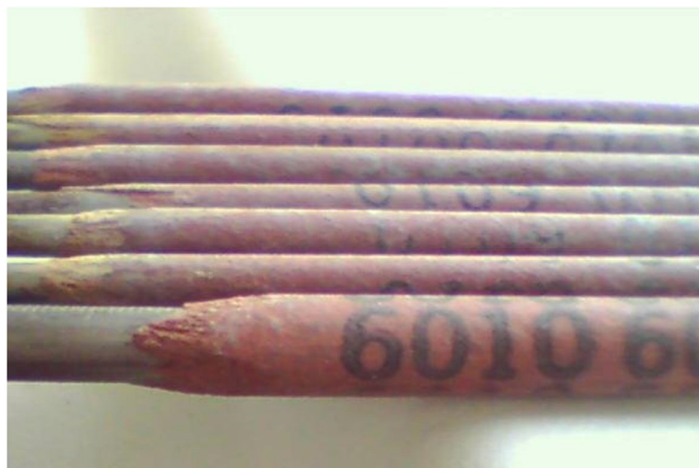
Figura I.8.- Electrodo con recubrimiento empleado en la actualidad
