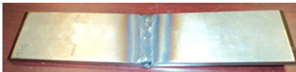
Figura V.7.- Probeta utilizada en el análisis experimental TIG
