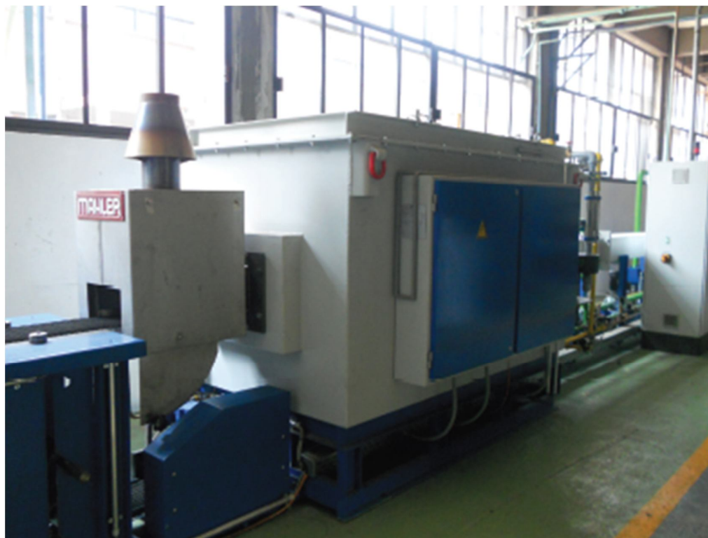
Figura VI.5.- Horno utilizado en el proceso de recocido
