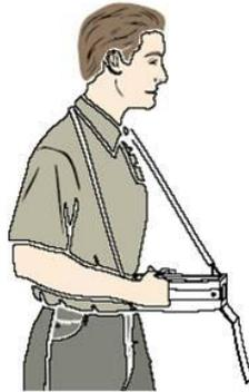
Figura 3.2 Posición del analizador para realizar mediciones a través del aire
