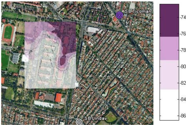
Figura 3 Nivel de potencia de CPICH del SC 246
